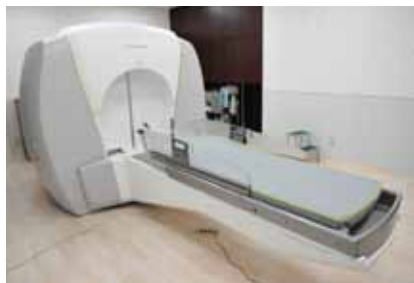
11年8月に三愛病院に導入された最新ガンマナイフ・パーフェクション。ガンマ線の精度も0.05mm(髪の毛半分)という、他の放射線治療と比較しても群を抜く治療精度である。
